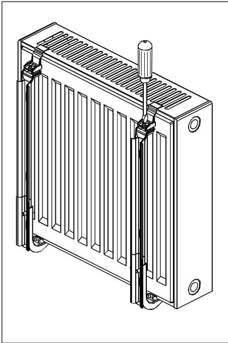
Heizkörper ausrichten und den oberen Halter mit Schraubendreher oder Steckschlüssel (5 Nm) anziehen.
