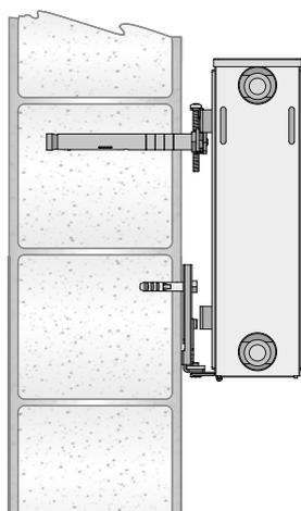
**Aushebe- und Verschiebesicherung**
