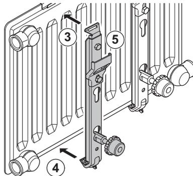
3. Obere Haken der Schnellkonsole in die Kralle einsetzen.
