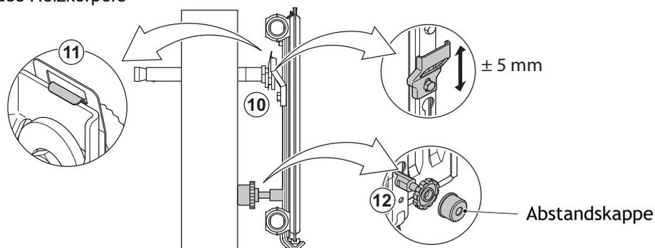
10. Heizkörper mit den Einhängelaschen der Schnellkonsolen auf die Bohrkonsolen aufsetzen.
