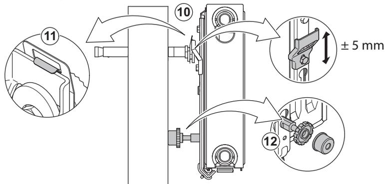
10. Heizkörper mit den Einhängelassen der Schnellkonsolen auf die Bohrkonsolen aufsetzen.
