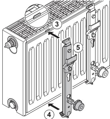
3. Obere Haken der Schnellkonsole in die Kralle einsetzen.
