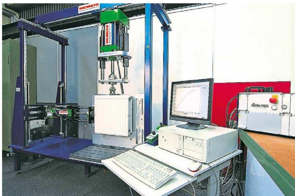
den charakteristische Werte mit Teilesicherheitsbeiwerten berücksichtigt. Bei der Anforderungsklasse 2 werden 250 N vertikale Kraft von unten angesetzt (selten bis gelegentliche Belastung durch haushaltsübliche Reinigungsgeräte), bei der Anforderungsklasse 3 werden 500 N angesetzt (höhere und häufigere Belastung durch z. B. professionelle Reinigungsgeräte von Dienstleistern) und bei der Anforderungsklasse 4 werden 1.000 N angesetzt.
