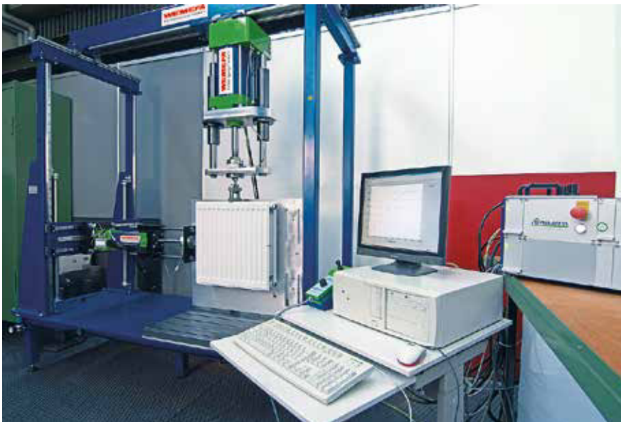
Prüfstand der Wemefa GmbH für die Entwicklung und Zertifizierung nach VDI 6036.
